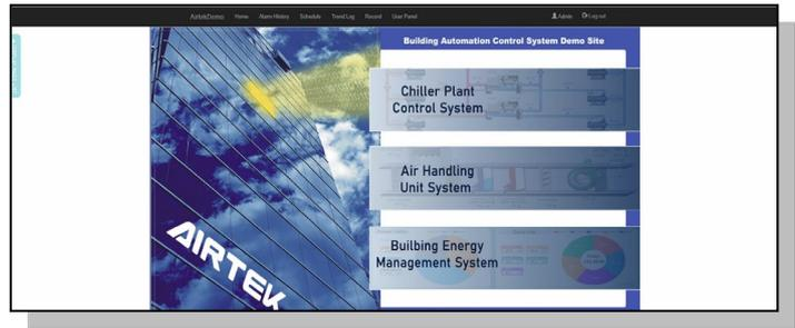
■ **簡易資料分享**→因採用 Web Sever 架構，任何有 Client 端的操作/存取/紀錄等皆使用同一資料庫；不再像傳統多台 SCADA 共用資料庫時需複雜的 Client/Server 設定。
