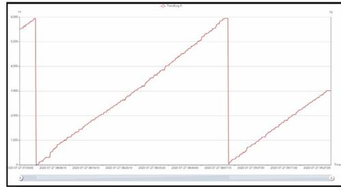
■ **多筆顯示**→可設定最多同時達 9 個紀錄曲線同時顯示，各紀錄曲線之顏色可由使用者自行設定，各曲線也於檢視時隨時切換顯示/不顯示；系統紀錄較多時也提供簡易的搜尋列以選取所需紀錄。另檢視紀錄的 X/Y 軸範圍也可隨時以滑鼠控制 Zoom In/Out，設定選擇完成的趨勢圖也可直接另存為圖片列印出，可儲存的圖檔類型包括 emf、png、gif、jpeg、tiff、bmp 等六種，以方便比對各種紀錄在各不同時間範圍內的差異。
