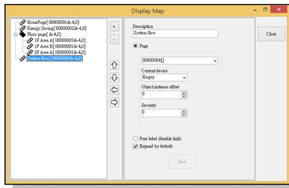
■ **動態圖板製作**→BACsoft 提供靈活的動態圖版製作功能，使相同布置(Layout)但不同器件或資料的圖板可透過簡單設定統一，無須重複製作，大幅節省圖版製作及維護的時間。
