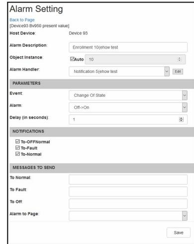
■ **BACnet 標準通告物件管理**→具新增、刪除、編輯、記錄及接收 AIRTEK 系統中的 B-AAC 等級以上所有控制器通告之功能，亦可處理符合 BACnet 通訊不同品牌的設備通告，達到系統整合需求；警報搭配通告的應用可使多個警報參考相同的通告清單、人員、或設備，無須個別警報重複設定，減少警報及事件管理及維護的時間。
