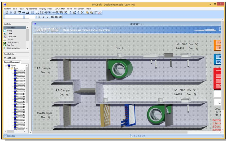
■ **圖板管理**→專案的圖控即是由許多的圖板所結合而成，提供圖板管理工具如清單、設定、儲存等供專案應用，使用者並可自行製作圖板樹狀地圖(Tree map)，令使用者在執行模式下操作時更容易了解各圖板間的相對關係。
