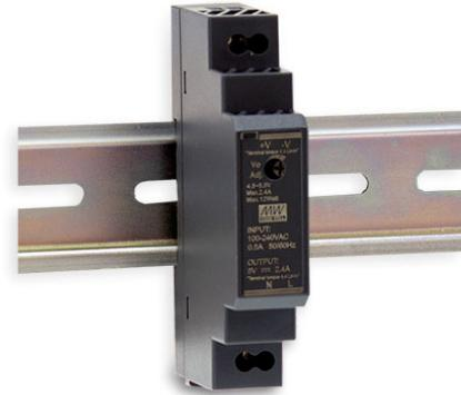
HDR-15-24 採用塑膠外殼設計，可有效防止使用者觸電危險。系列產品工作效率高達 87%，可在-30°C 至 70°C 環境溫度下以空氣對流方式運作。配備恆流模式過載保護功能，適用於各類感應性或電容性應用。憑藉完備的防護功能及適用於家庭自動化與工業控制設備的相關認證 ( IEC60950-1、UL508、UL60950-1、EN61558-2-16 )，HDR-15 成為家用與工業應用領域極具競爭力的電源解決方案。
